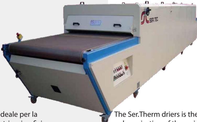
La linea dei forni Ser.therm è ideale per la polimerizzazione degli inchiostri serigrafici su qualsiasi materiale. Concepiti in maniera modulare, sono studiati per un'alta resa a bassi consumi. Costruiti in acciaio e verniciati a polveri, sono dotati di pannelli coibentati.
