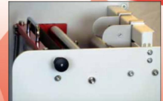
La lama per il taglio longitudinale è regolabile ed è possibile il riavvolgimento su più bobine
